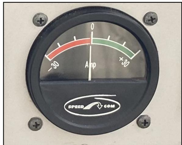
Una indicación de una falla del alternador sería mostrada en una indicación de descarga del amperímetro. Los amperímetros deben indicar una carga cero en operaciones normales. Una condición de descarga, señalada por una indicación negativa significa que la batería se está agotando. ¿Por qué? El alternador ya no lo carga y los componentes del sistema eléctrico están robando la energía de la batería.
