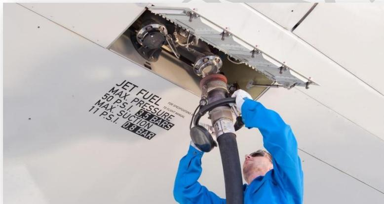
La chispa de intensidad suficiente para encender el vapor de combustible puede resultar de la descarga de energía electrostática (estática)
